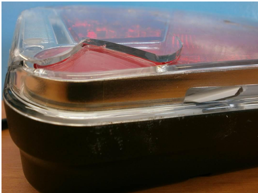
Rys. 3 Widok spowodowanych uszkodzeń po próbie IK09;
