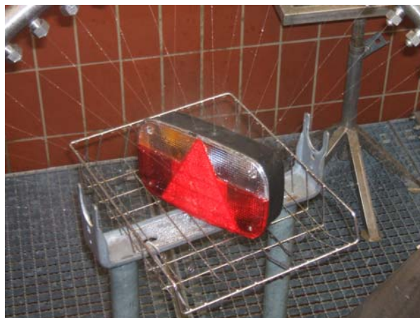
20: Multipoint III: IP X4-Prüfung
