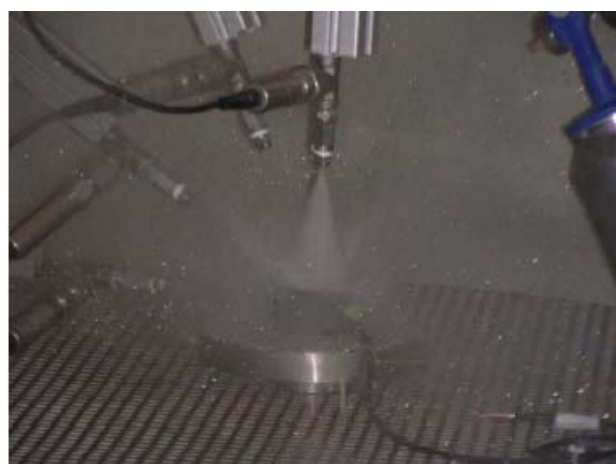
15: RDC Sensor Dampfstrahlprüfung
