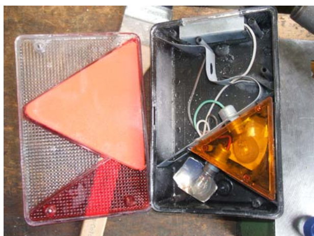
11: Multipoint IV: wenig Staub eingetreten
