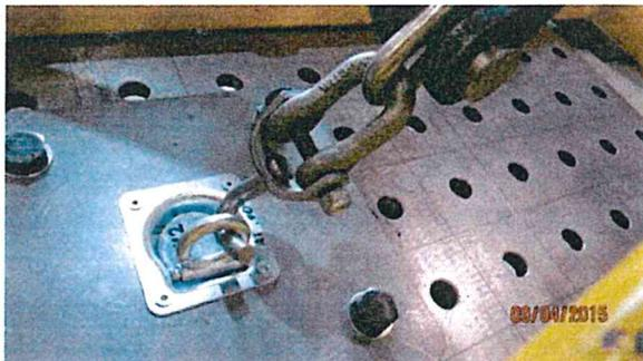
Diese Prüfplatte wurde sowie das Zurrpunktprüfgerät wurden am Lochtisch jeweils verschraubt.
